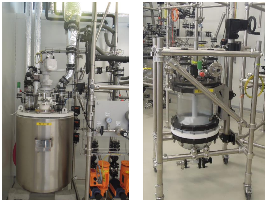
Abbildung 41: 100 L-Reaktor mit aufgesetztem Kondensators (links) und 25 L-Filtereinheit (rechts).
