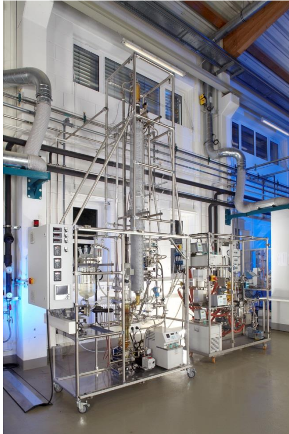
Abbildung 44: Hochtemperaturrektifikation (links) und Kurzwegdestillation (rechts).
