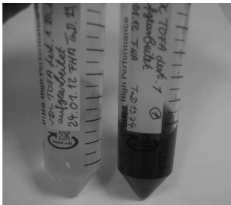
Abbildung 106: Farbentwicklung bei der chemo-enzymatischen Epoxidierung verschiedener Tallöl-Fettsäure-Fractionen mit Novozym® 435 jeweils im Vergleich zu einem Blank-Ansatz ohne Enzymzugabe. (A) Fettsäure-Fraktion VDL TOFA dest. 1; (B) Fettsäure-Fraktion VDL TOFA dest. 2.
