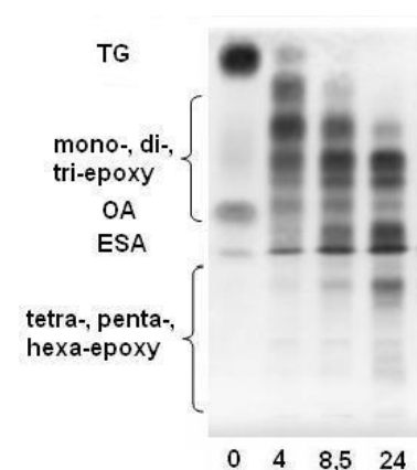
Abbildung 102: Dünnschichtchromatographische Analyse der Umsetzung von (A) Ölsäure, (B) Linolsäure, (C) Linolensäure, (D) Erucasäure, (E) Ölsäuremethylester, (F) Öl 1, (G) Öl 2 und (H) Öl 3 bei optimierten Reaktionsbedingungen.
