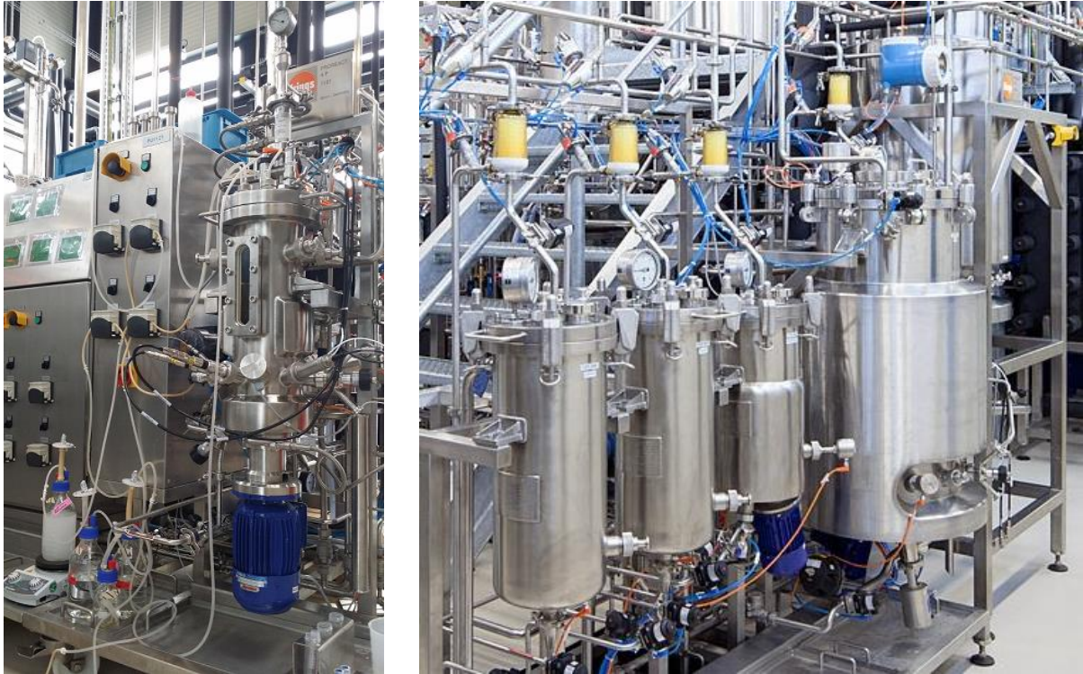
Abbildung 135: 10 L-Fermenter (links) und 300 L-Fermenter (rechts) der Fa. Frings am Fraunhofer CBP.
