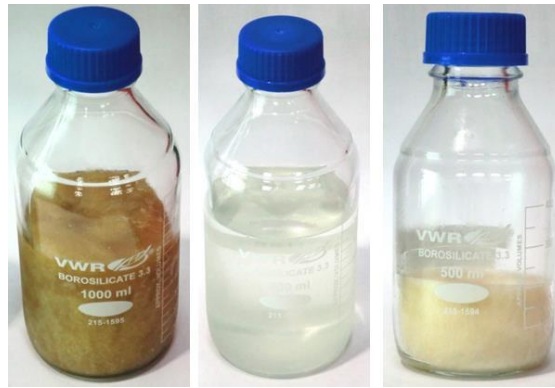
Abbildung 50: Edukt (links) - Aufgereinigte Fraktionen (Octadecen (Mitte)) und Dimethylester (rechts).
