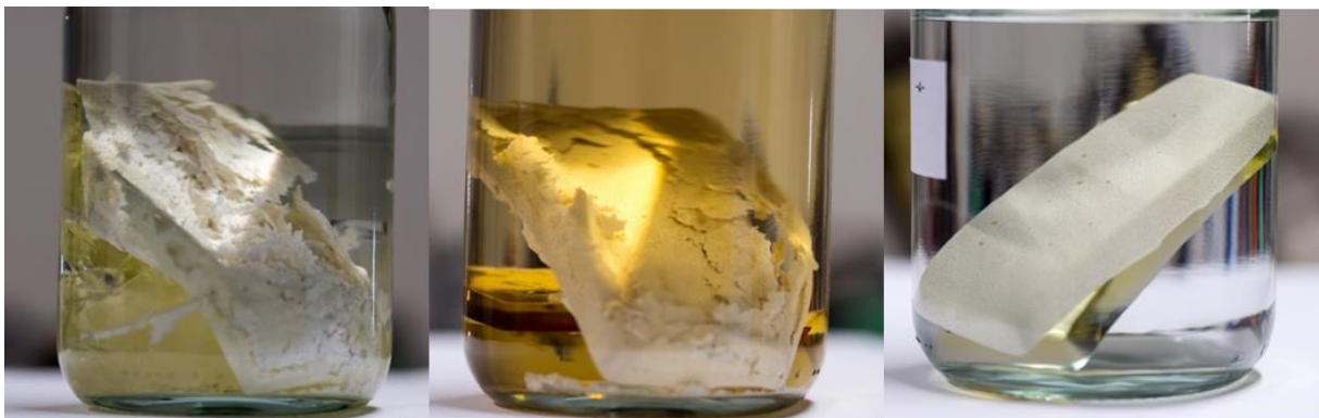
Abbildung 182: Beständigkeit eines Prüfkörpers gegenüber Ethylacetat (links), Benzin E10 (mitte) und Wasser (rechts).
