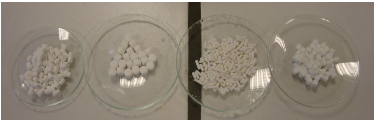
Abbildung 64: Verschiedene Beispiele für feste Säurekatalysatoren, die in einem Festbett-Gasphasen-Testreaktor getestet wurden.
